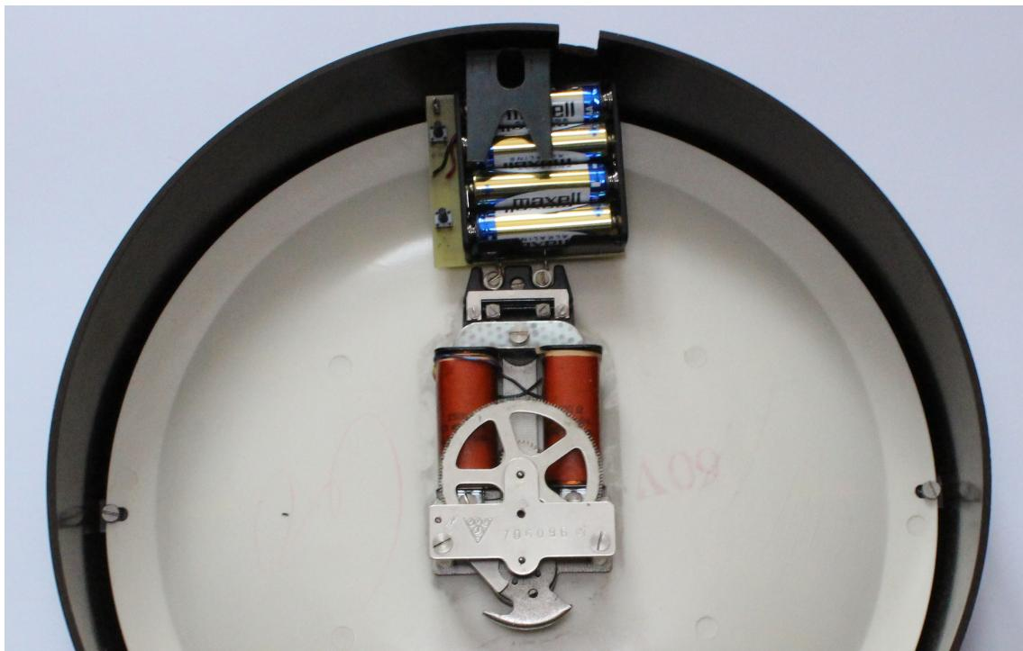
Obrázek 4.: Foto bateriových matečních hodin umístěných ke strojku PS-3.
